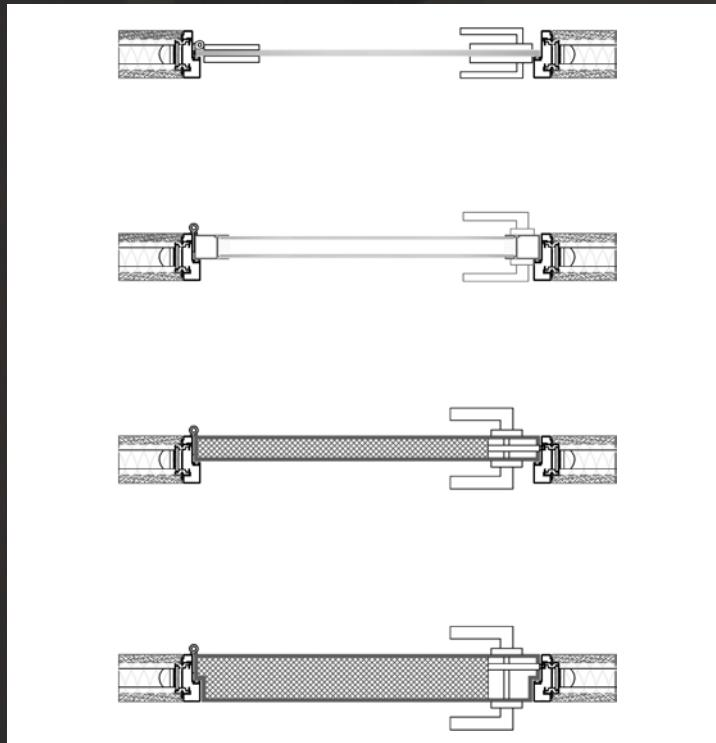
SECCIONES HORIZONTALES PUERTAS CORREDERAS / HORIZONTAL SECTIONS OF SLIDING DOORS / SECTION HORIZONTALES PORTES COUILLANTES
