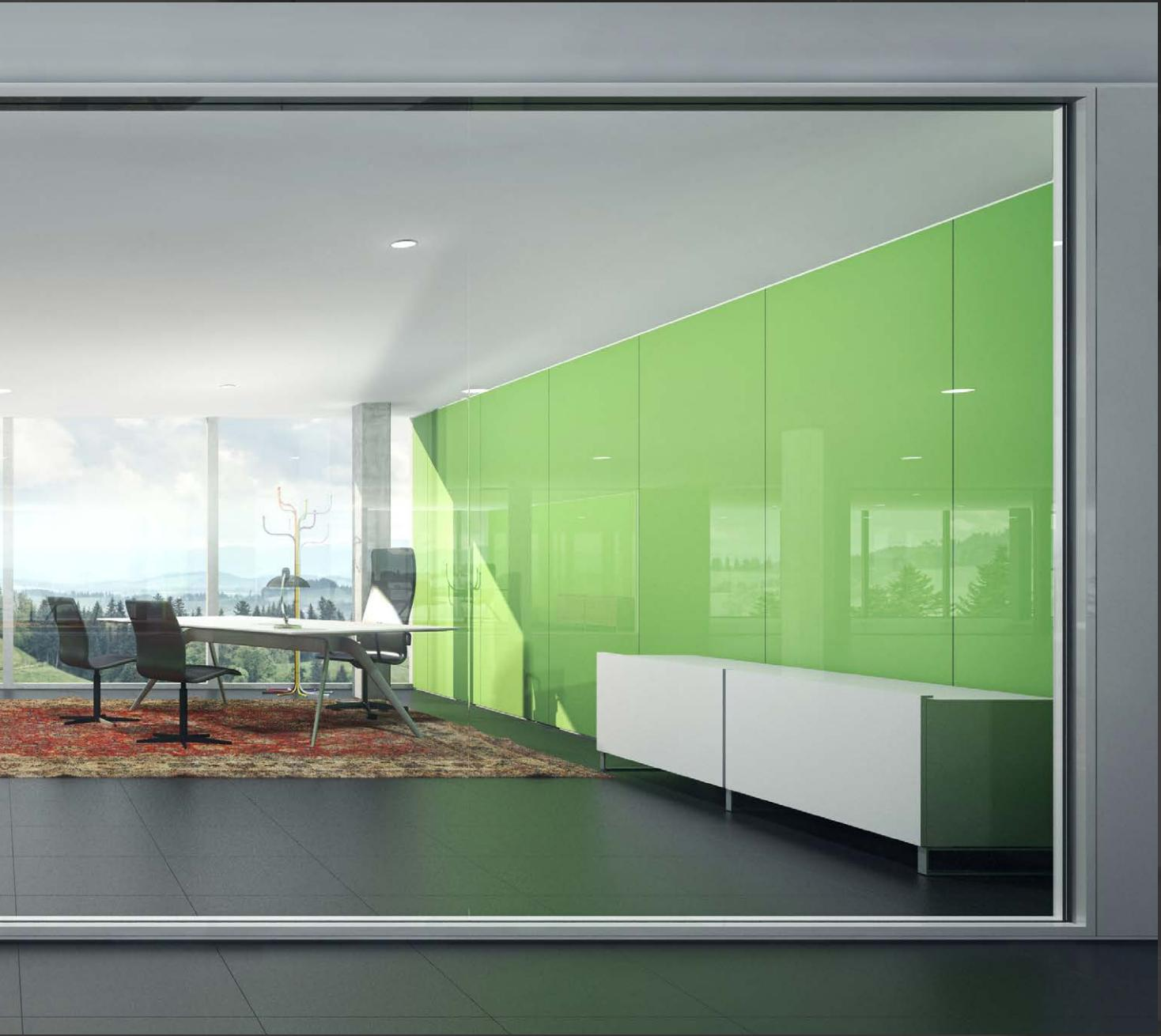
La opción estética de un solo vidrio al eje central del muro alcanza una atenuación acústica de 38 db y resuelve con sencillez la mecánica y estética del conjunto de la instalación.
